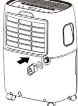
Cev za odpadno vodo vstavite v priključek za odvajanje vode.
