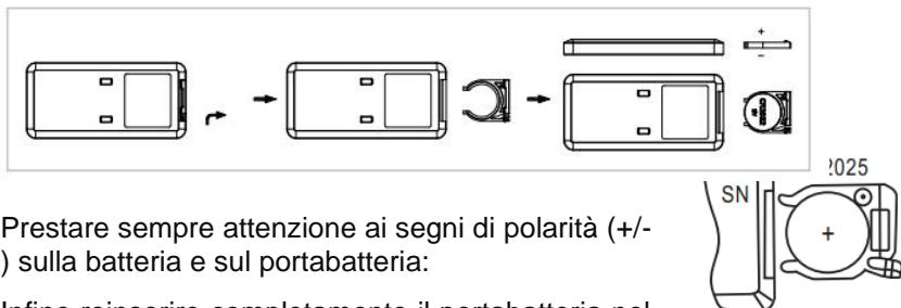
3. Prestare sempre attenzione ai segni di polarità (+/-) sulla batteria e sul portabatteria:
