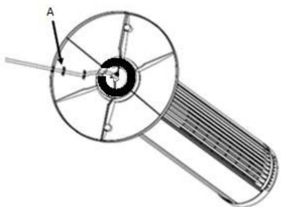
Na kraju provucite kabel za napajanje
