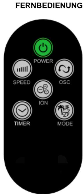
Für die Inbetriebnahme der Fernbedienung ist die Sicherungslasche beim Batteriefach herauszuziehen um diese zu aktivieren.
