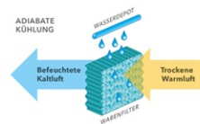
Luftkühler Funktionsprinzip
